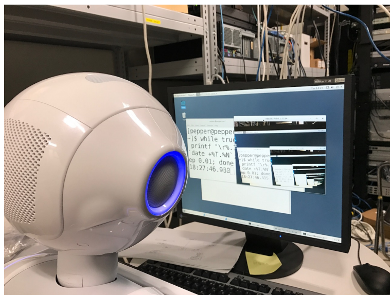
図 17: ライブストリーミング映像のエンド間の遅延計測の方法
