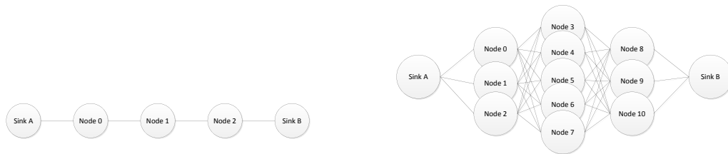
(a) 前向きノードの数と後向きノードの数が同じであるトポロジーの例 (b) 前向きノードと後向きノードの数が異なるトポロジーの例
