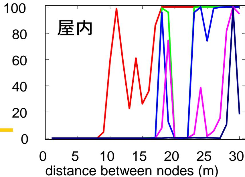
通信距離 = パケット損失率5%以下である距離
