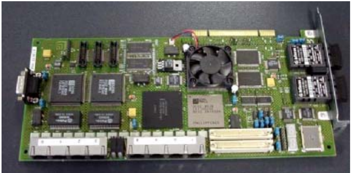
図 8: ネットワークプロセッサボード ENP2505
